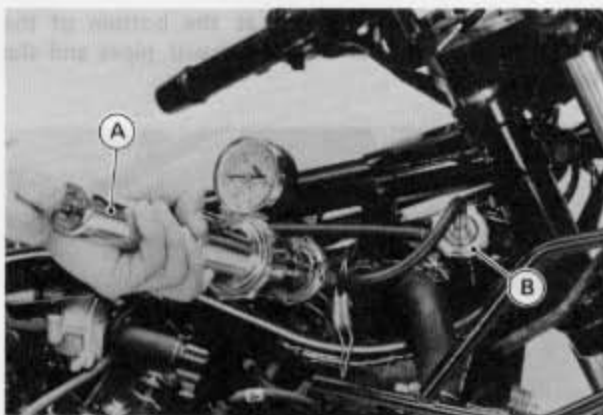
A. Pressure Tester B. Adapter
